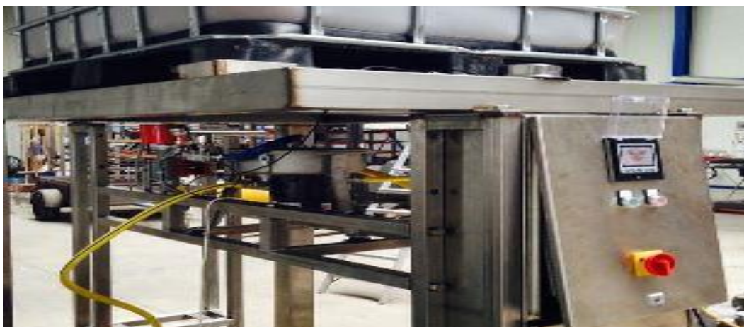
Afbeelding 3: Centrifuge met besturingskast voor gehele installatie
