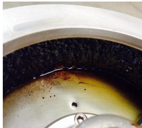
Afb. 2: Achtergebleven vuil in centrifuge
